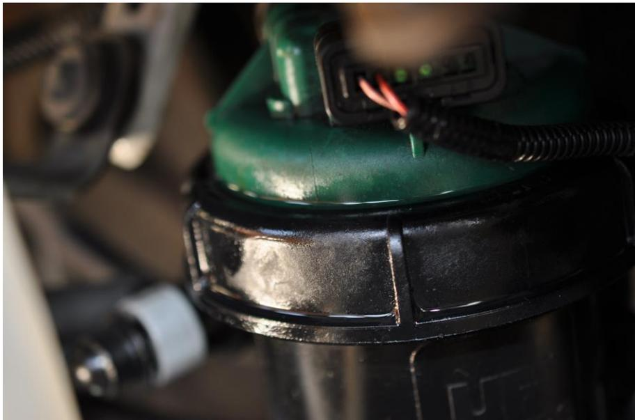
Auf dem Bild oben sieht man einen undichten Deckel. Der Kraftstofffilter muss absolut dicht sein und darf kein Diesel verlieren. Außer dem unangenehmen Geruch besteht **akute Brandgefahr**.
