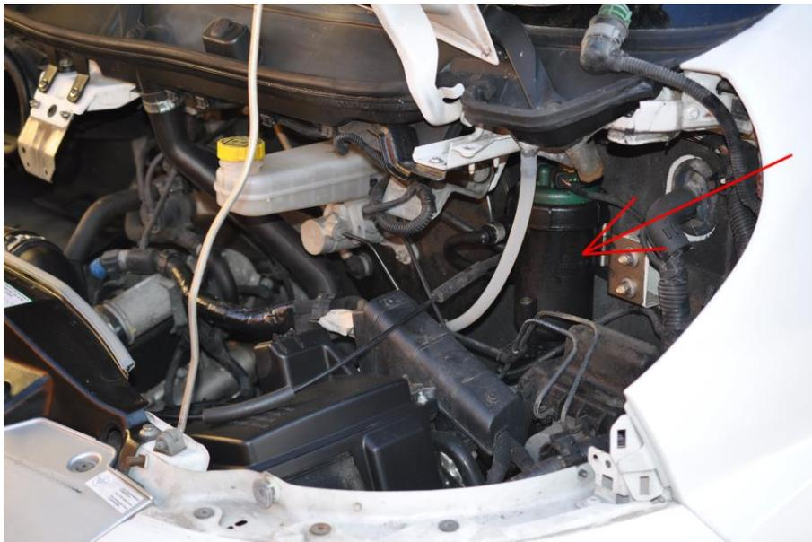
Nach dem Ausbau des Scheinwerfers, er wurde hier nur auf der Windschutzscheibe abgelegt, kommt man gut an den Kraftstofffilter heran. Zuerst werden die beiden elektrischen Anschlüsse abgenommen. Dazu am oberen den Schieber zurück schieben und dann den Anschluß abziehen. Am unteren Anschluß befindet sich eine Sicherungsfeder unter dem Stecker, diese muss nach oben gedrückt werden, dann kann man den Anschluß abziehen.
