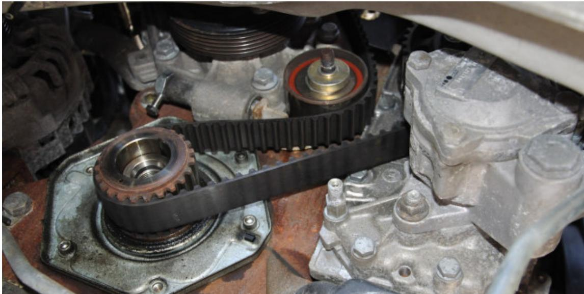
*Unterer Zahnriemenbereich bei abgenommener Abdeckung und Riemenscheibe, Kurbelwelle mit Markierung, Spannkolben mit eingesetzter 14er Mutter, Spannrolle*
