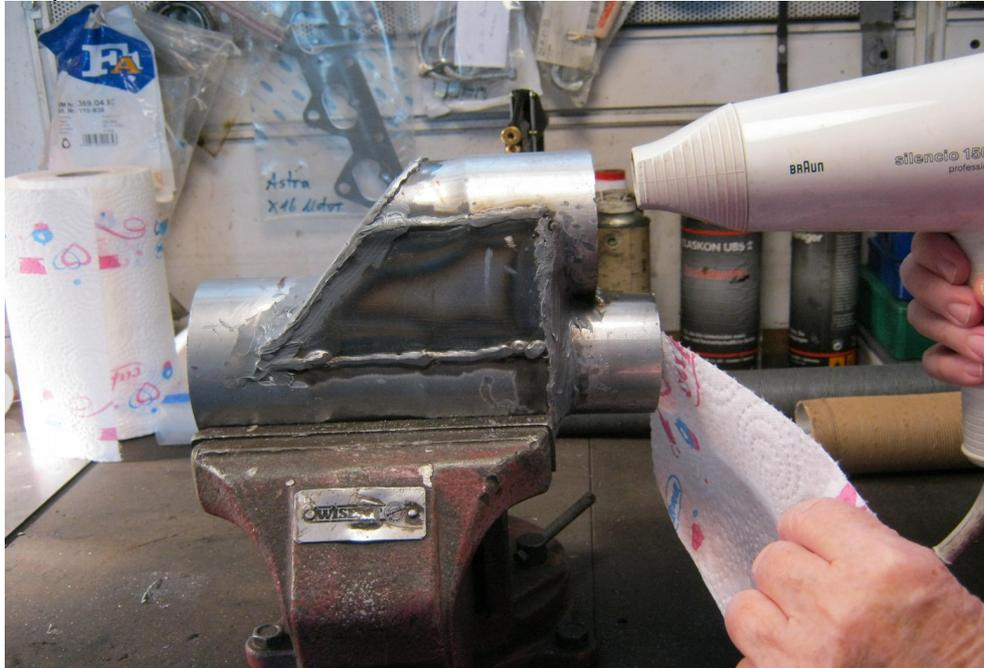
Funktion des Ejektors – oben kommt die Luft vom Heizungsgebläse und unten wird die Warmluft aus dem Schrank abgesaugt
