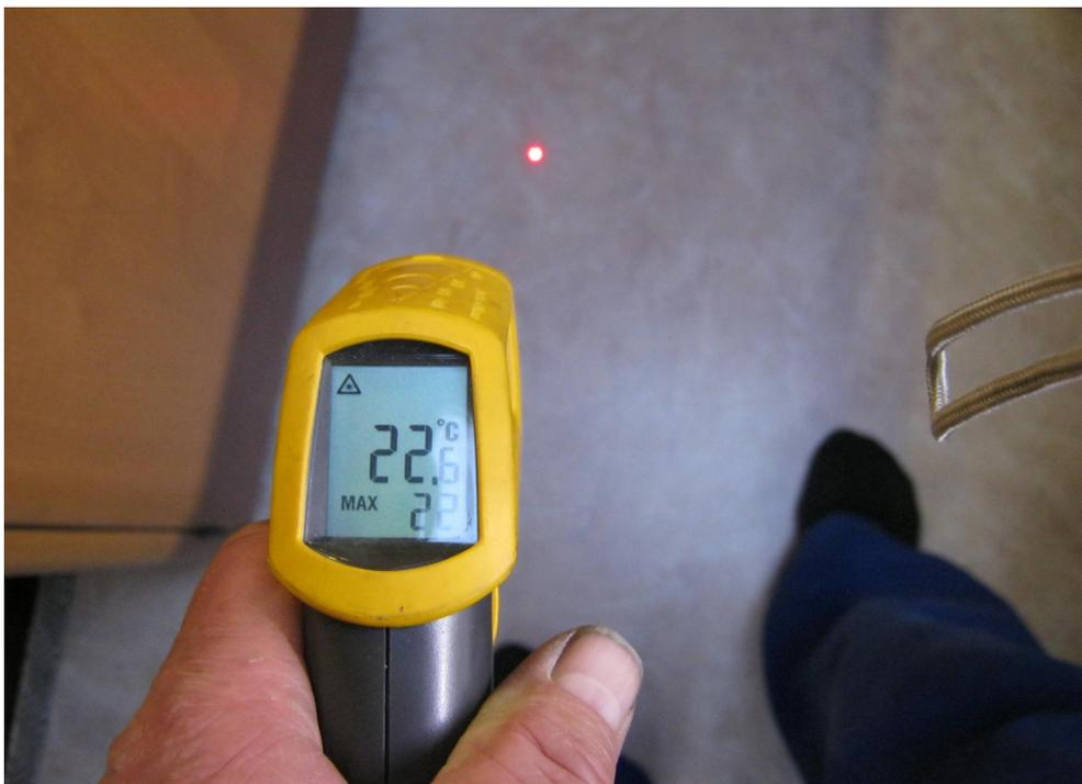
Die warme Luft bewegt sich am Fußboden nach vorn und erwärmt diesen bis auf Höhe des Kühlschranks. Am Luftaustritt sind es ca. 30 °C und vor dem Kühlschrank immer noch fast 23°. Geheizt wurde mit Stufe 7 der Truma bei ca. 8° Außentemperatur. Die niedrige Stufe des Gebläses reicht zum heizen vollkommen aus.
