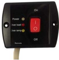
Wir liefern serienmäßig eine Fernbedienung mit 6m Kabel mit. Die Fernanzeige ist mit einem Ein- und Ausschalter, sowie mit drei LED Lampen ausgestattet. Die LED Lampen signalisieren den Betrieb, Überlast und Übertemperatur. Bei ausgeschaltetem Wechselrichter wird keine Energie aus der Batterie entnommen.
