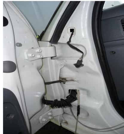
Das Kabel muss irgendwie in die Tür. Von den Schaltern zur Gummi Durchführung kein Problem, aber dann. Mit Einziehspirale versucht in der A-Säule hoch. Von innen kann man die Bitumenmatte mit dem Finger durchstechen. Gegenüber dem Türkontaktschalter. Der Einziehdraht war immer sonst wo. Irgendwann war er fest und ging weder vor noch zurück. Also abschneiden, hängt jetzt in der A-Säule, hoffentlich klappert es nicht > tut es nicht.
