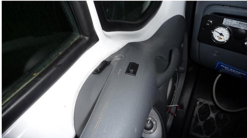
Links habe ich einen **Schalter** und **Taster** (Marquardt 1838.1402) für **ON/OFF** und **RES**. Rechts Zwei Taster (Marquardt 1838.1602) für Beschleunigung und Entschleunigung. Für mich **DIE POSITION** zum Cruisen.
