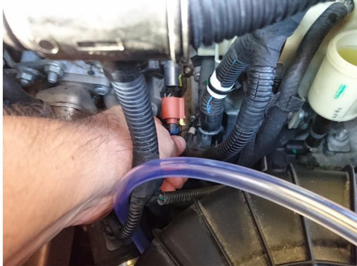
Zuerst sollte auch hier die Flüssigkeiten abgesaugt und durch neue ersetzt werden. Da die beiden Flüssigkeiten nicht gemischt werden dürfen, sollte man hier unbedingt eine 2. Spritze verwenden. Beim Öffnen des Deckels sollte man beide Hände benutzen (den Behälter mit der 2. Hand fixieren), weil sich sonst die Haltekupplung lösen kann.
