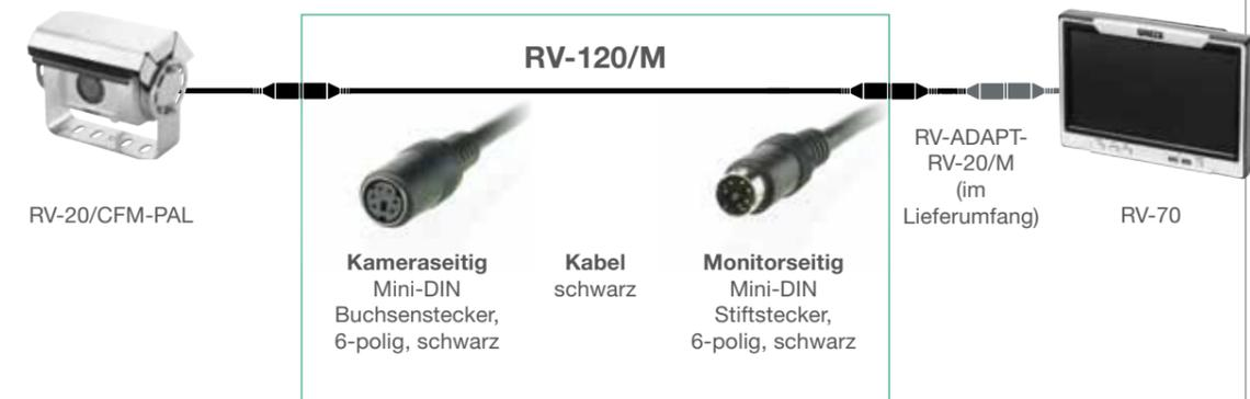
**System-konfiguration aus aktuellen WAECO Kameras und Monitoren**
