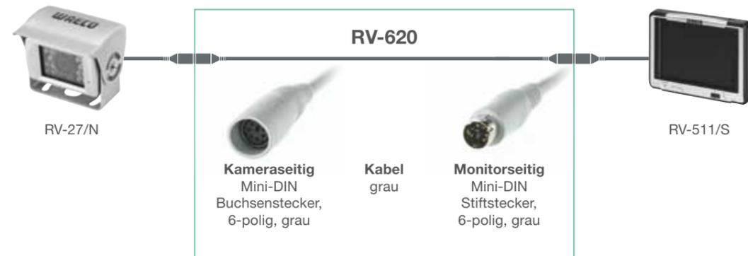
**System-konfiguration aus aktuellen WAECO Kameras und Monitoren**
