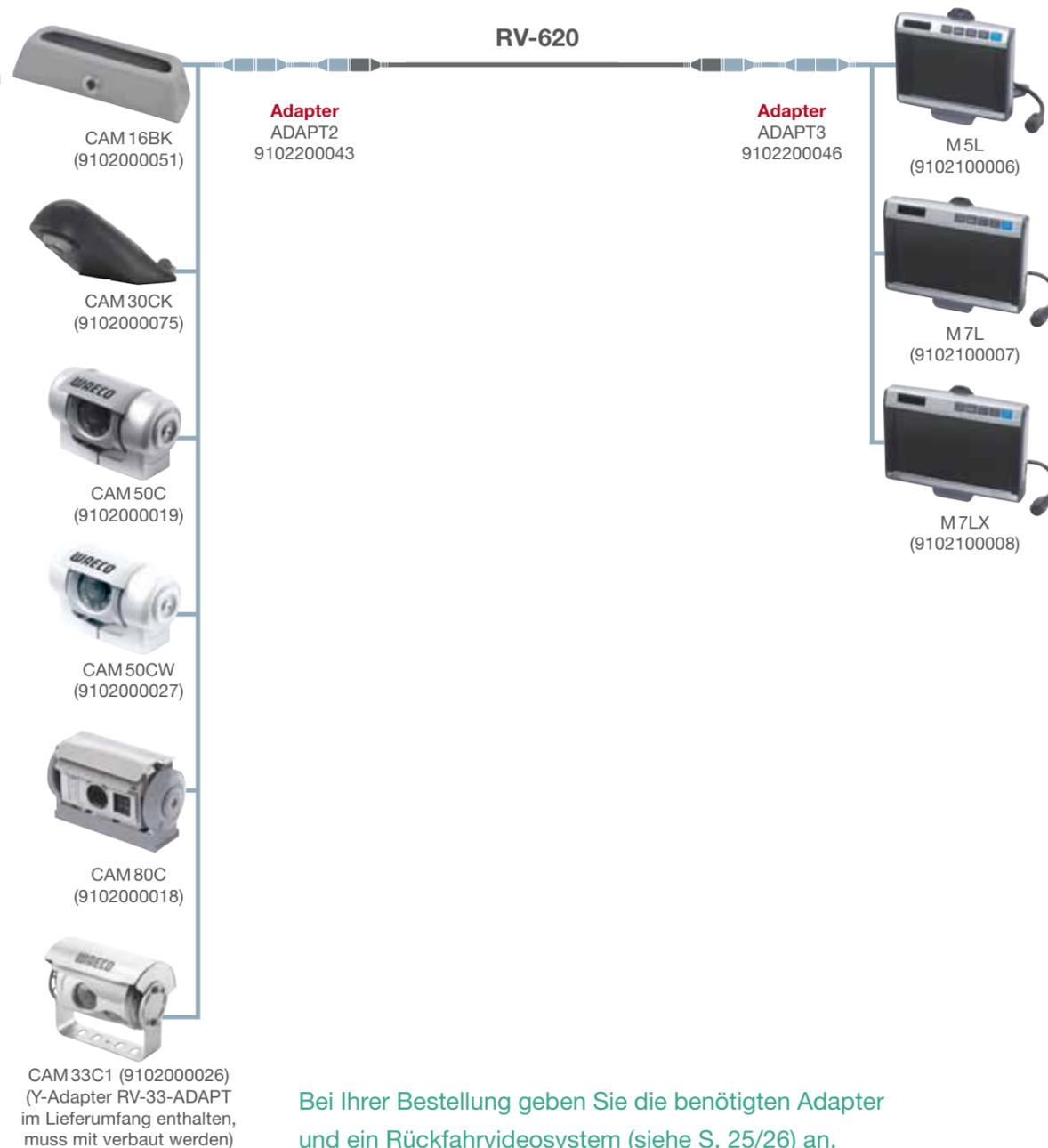
**System-konfiguration aus aktuellen WAECO Kameras und Monitoren**
