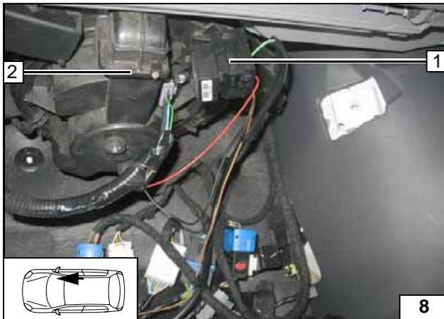
IPCU 1 an vorhandener Schraube vom Gebläsemotor 2 montieren!
