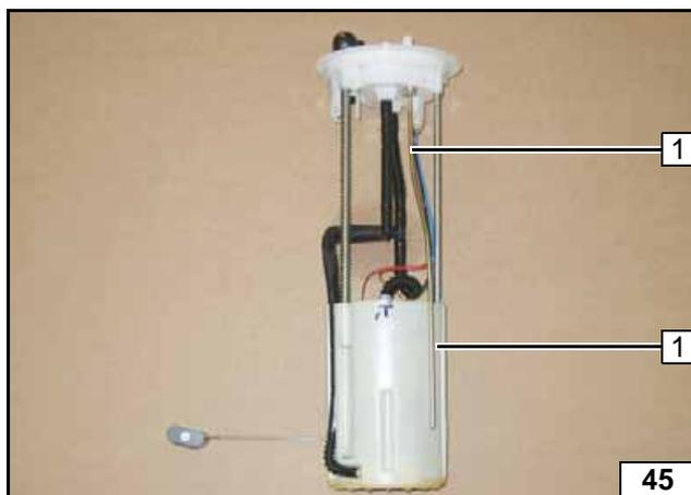
Tankentnehmer 1 gemäß Schablone formen, ablängen und einsetzen, siehe „Einbauanweisung“!
