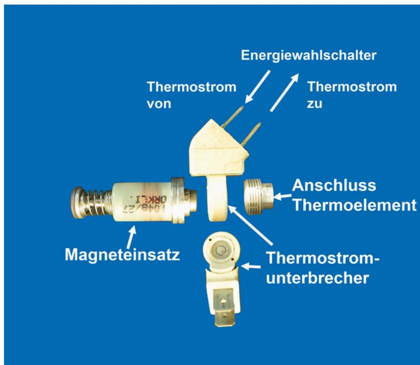
Die Thermospannung wird vor dem Magneteinsatz durch den Thermostromunterbrecher zum Energiewahlschalter geleitet. Bei der Einstellung „Gas“ wird der Thermostrom dann zum Magneteinsatz weitergeleitet.
