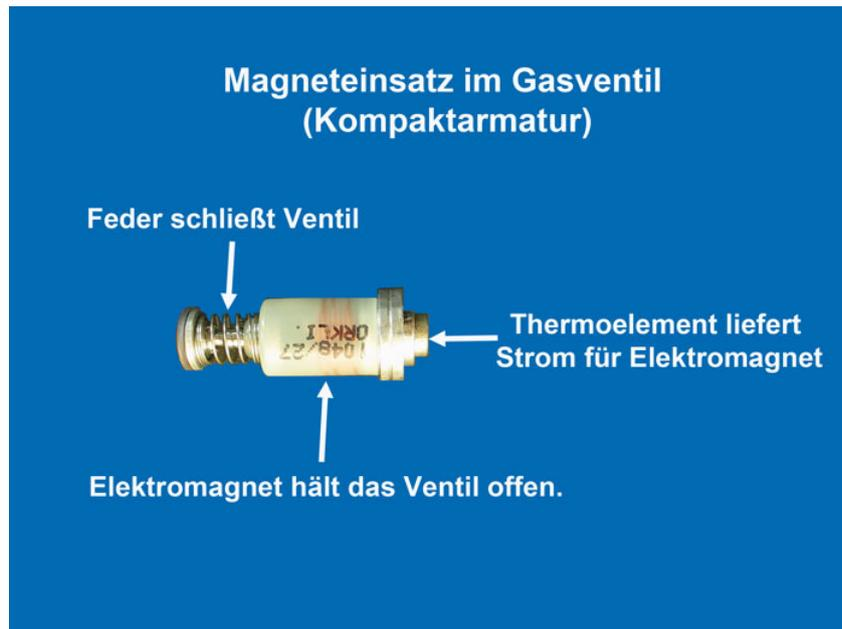
In der Kompaktarmatur (Gasventil) befindet sich ein Magneteinsatz an den das Thermoelement angeschlossen ist. Das Thermoelement erzeugt durch die Temperatur der Flamme eine Thermospannung, dadurch wird der Magneteinsatz angezogen und das Ventil offen gehalten.
