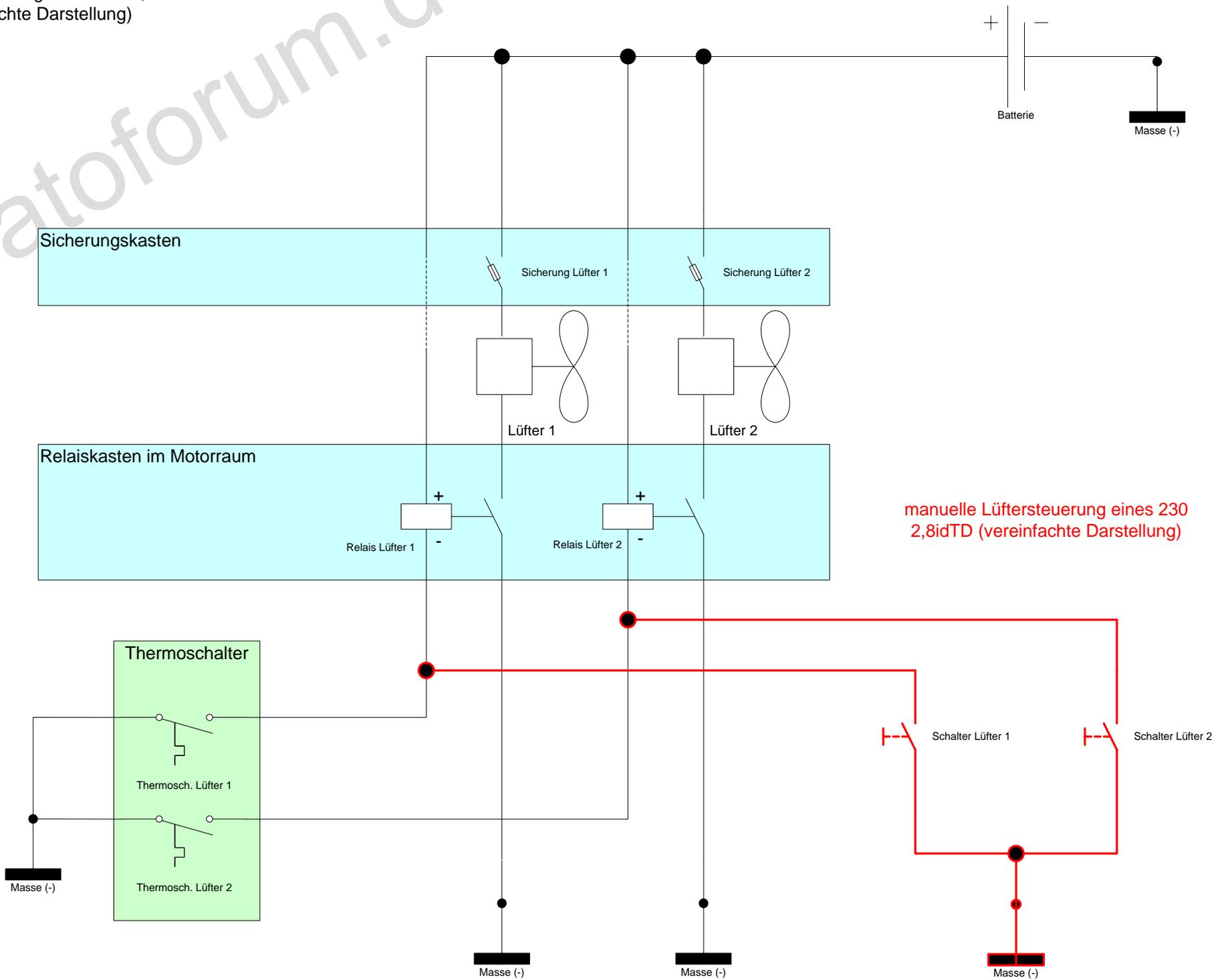
manuelle Lüftersteuerung eines 230
