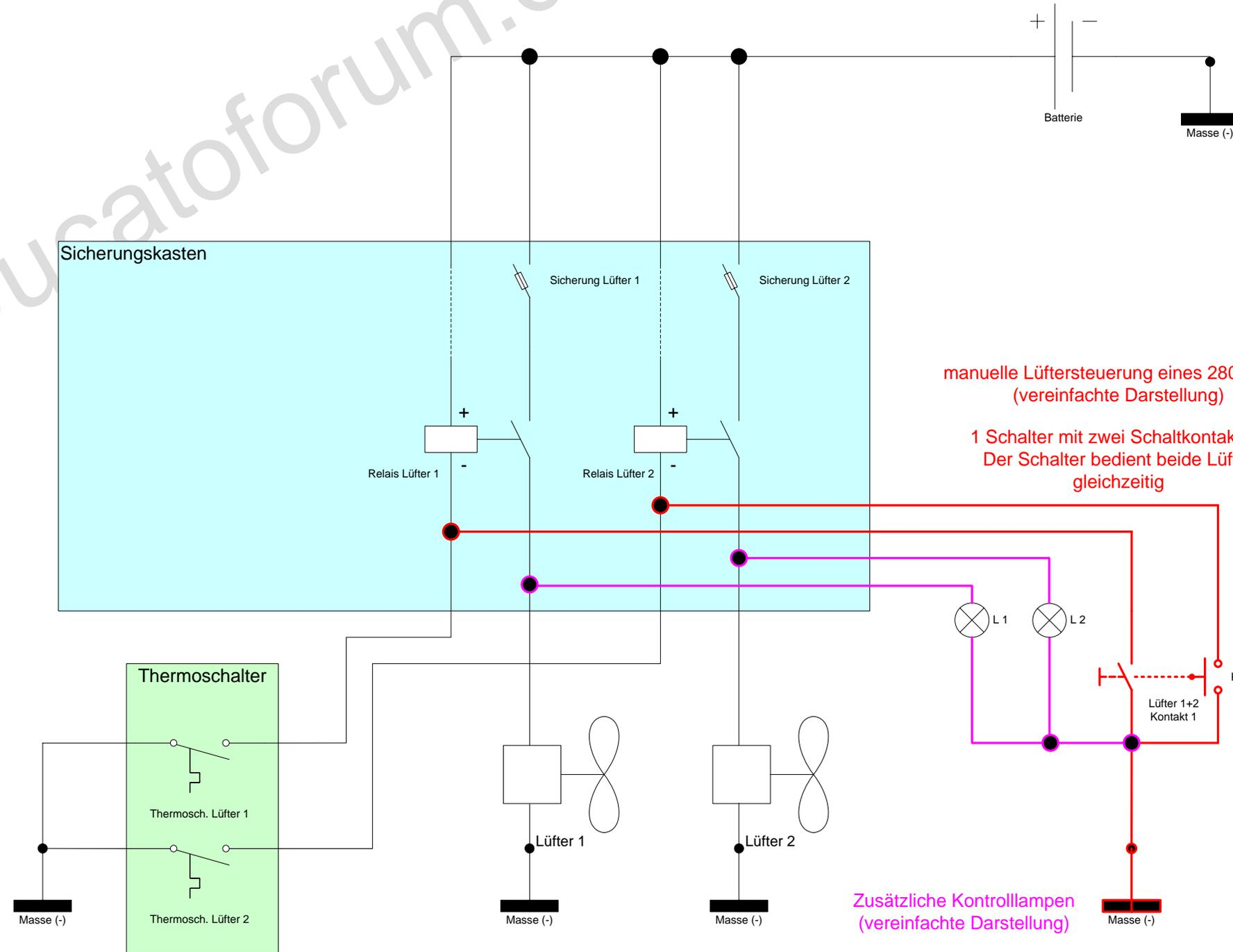
manuelle Lüftersteuerung eines 280 1.9TD
