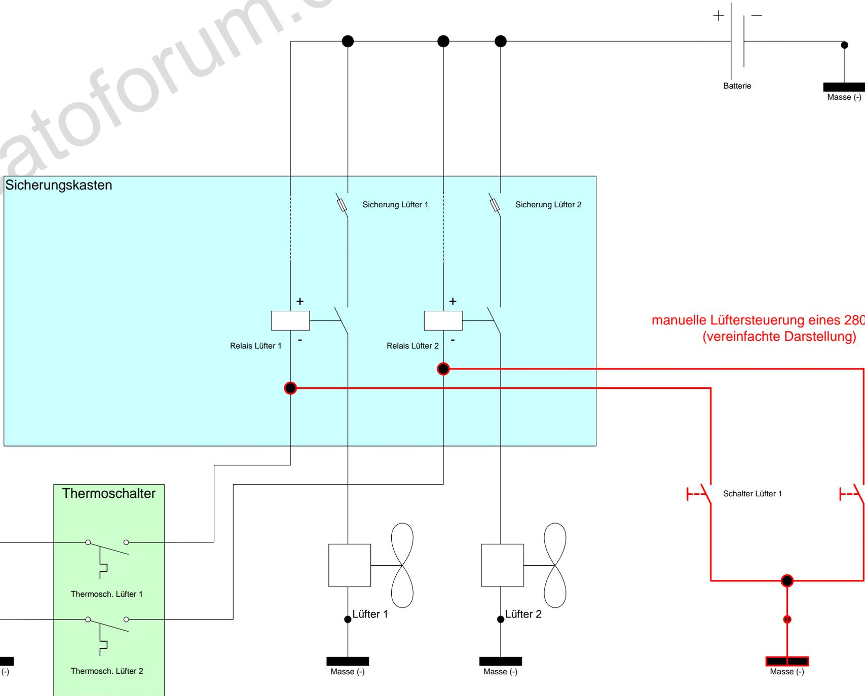
manuelle Lüftersteuerung eines 280 1.9TD
