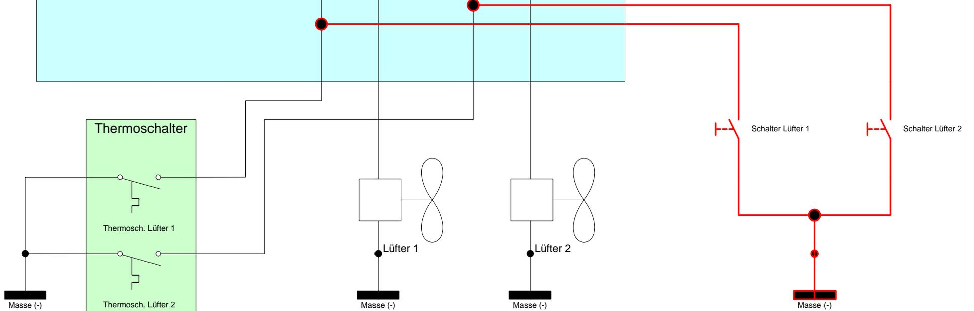
Original Lüftersteuerung eines 280 1.9TD
