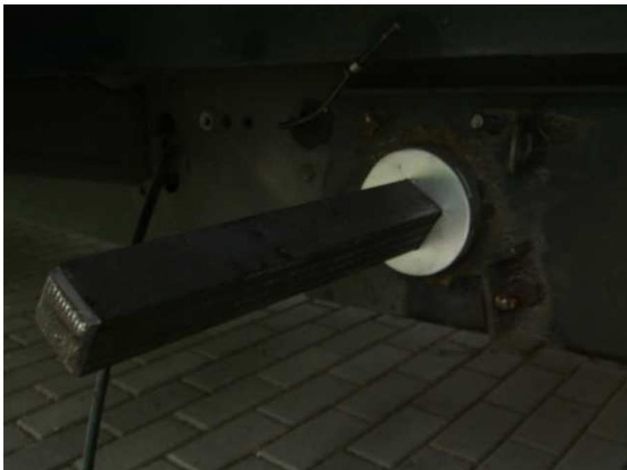
Mit einem Kupferdorn wird nun das Federpaket „eingetrieben“. Was sich nach großem Kraftaufwand anhört, aber nicht war. Das Paket wurde perfekt stramm eingesetzt, hier zeigte sich, dass die 2/10 mm Übermaß richtig waren.
