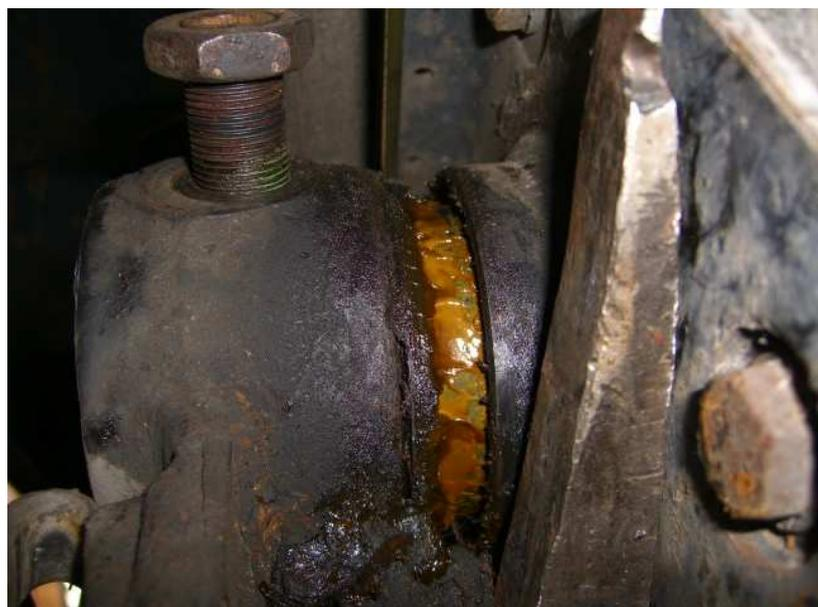
Nachdem sich nun die Achsschwinge vom Drehstab, hier bei dieser Achse handelt es sich um ein Federpaket, gelöst hat, zieht man die Schwinge vorsichtig, ohne zu verkanten, aus dem Achsrohr.
