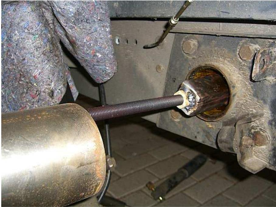
am Ende der gegenüberliegenden Seite wird die Schweißnaht plan geschliffen, darauf wird eine Mutter M 20 HV aufgeschweißt. In diese Mutter wird eine Gewindestange M 20 – 10.9er eingeschraubt.
