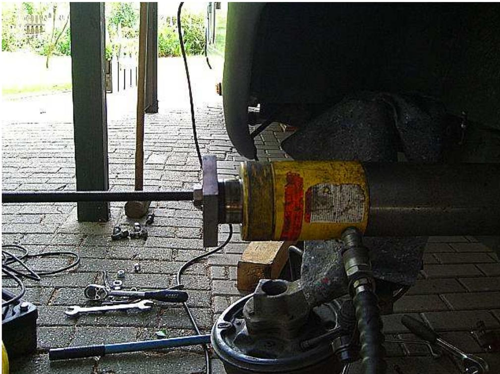
Nun wird das Aggregat in Gang gesetzt – das Federpaket wird nun unter den optimalsten Bedingungen gezogen. Nichts wird beschädigt – nirgendwo wird geschlagen!
