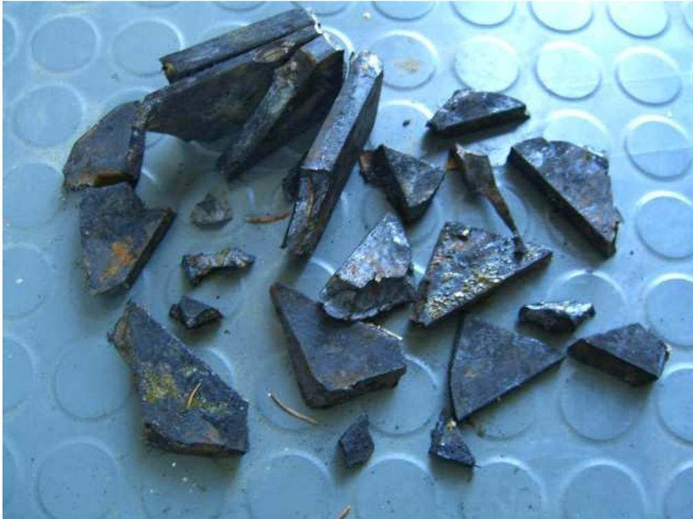
Zerborstene Federteile – gut erkennbar, das ist eindeutig ein Langzeitschaden. Also wenn das Fahrzeug optisch nicht mehr in der Waage steht, bei Gelegenheit eine Überprüfung, wie am Anfang geschrieben, durchführen.
