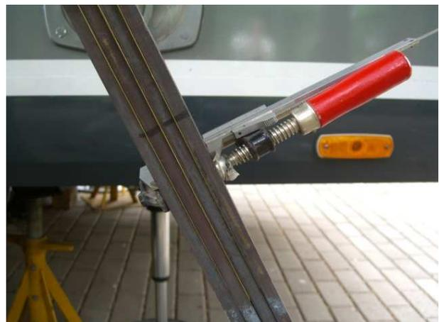
mit der Schraubzwinde wird das Paket gepresst um mit der Schieblehre messen zu können
