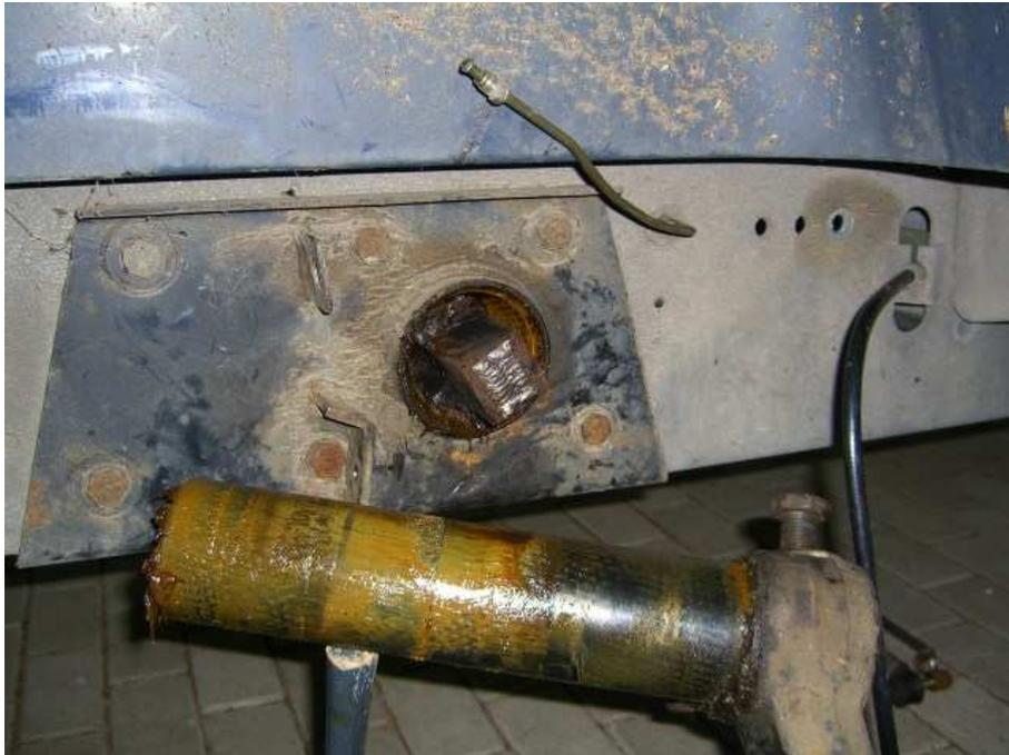
Die Achsschwinge wird nun vorsichtig abgelegt, da ja noch das Handbremsseil befestigt ist.
