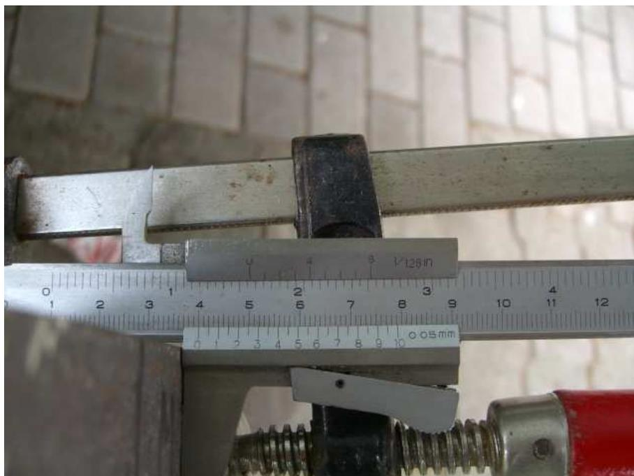
Damit die Futterbleche beim Einsetzen nicht verrutschen bzw. herausrutschen habe ich eine Klammer hergestellt – diese Klammer kann sich dann später beim Einsetzen des Paketes vor dem Widerlager verschieben.
