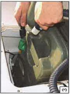
Cassette einschieben, Verschluss (schwarz) nach vorne abziehen, und Absaugschlauch auf Schlauchanschluss (grün) aufstecken.
